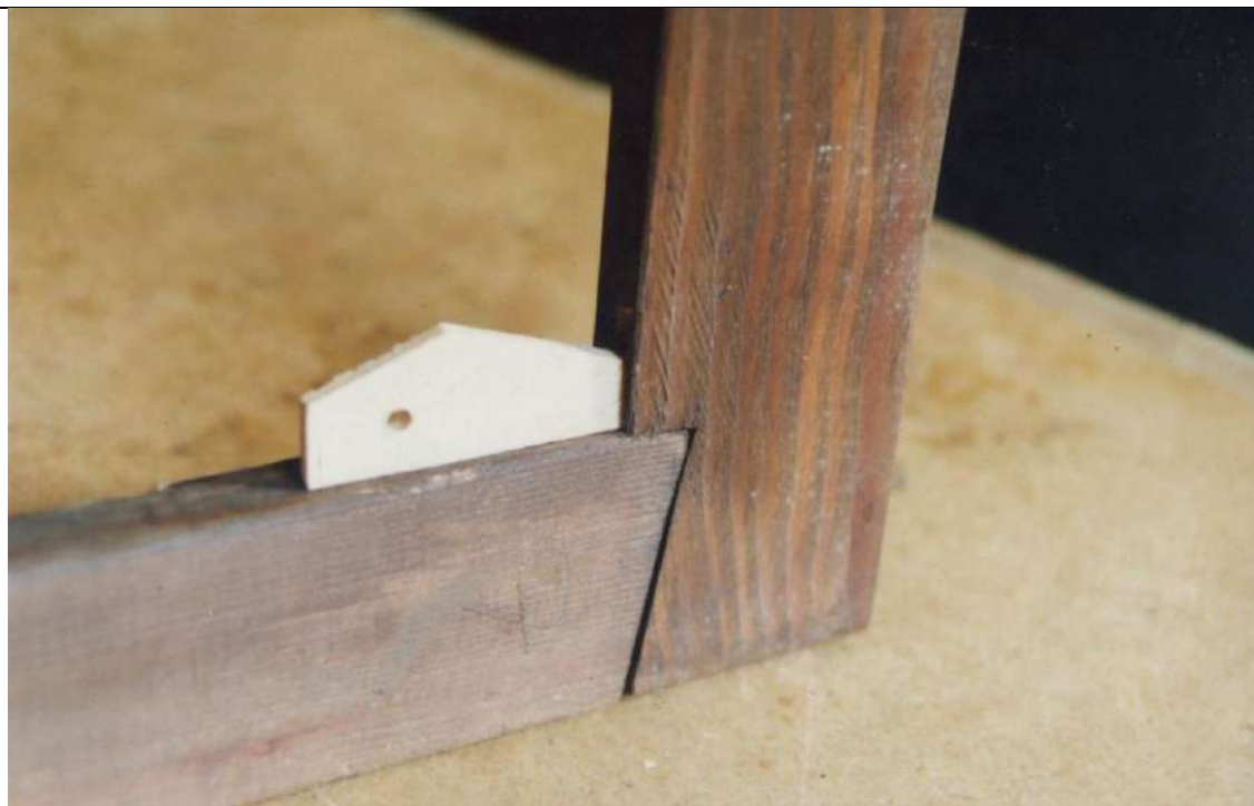
Угол подрамника раздвигается одним клинком.
