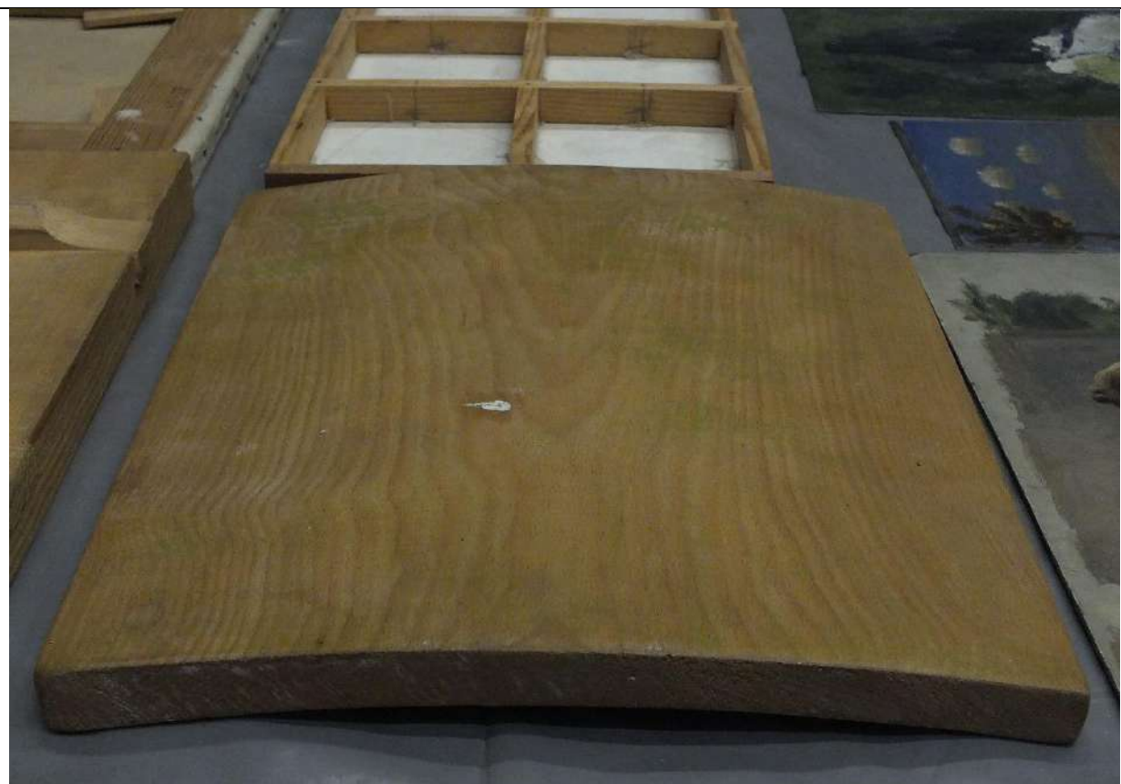
Тангентальный вырез доски. (Доска деформировалась).
