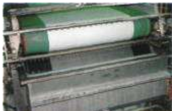
Круглосеточная бумагоделательная машина, установленная на комбинате St. Cuthbert's Mill в городе Сомерсет в Англии.
