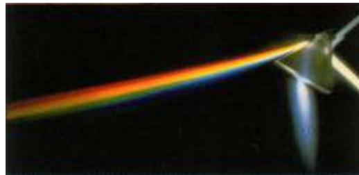
Рассеивание белого света. В процессе прохождения луча белого света сквозь плотную стеклянную призму он распадается на цвета спектра.
