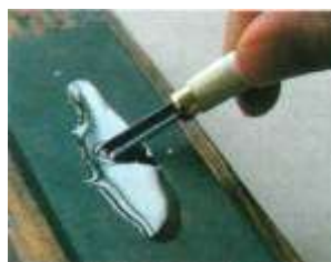
Затачивание стамески. Используйте вращающие движения в нижнем направлении, поворачивая стамеску из стороны в сторону в процессе скольжения ее грани по поверхности оселка.
