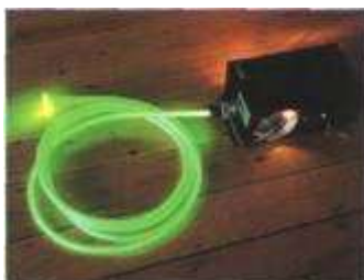
Проектор с волоконно-оптическими кабелями: зеленый фильтр
