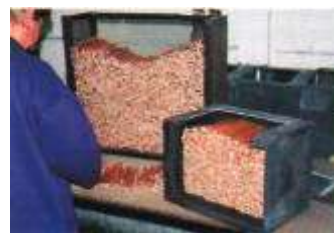
Процессы резки и упаковки. Сухие стержни связываются в пучки и распиливаются в соответствии с определенным размером. Затем они плотно укладываются в железные боксы для обжига, после чего подвергаются обжигу в печах.
