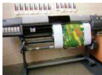
Цифровой принтер крупного формата. Эта машина выполняет отпечатки шириной до 1 метра на прочной бумаге высокого качества при использовании светостойких пигментированных красителей.
