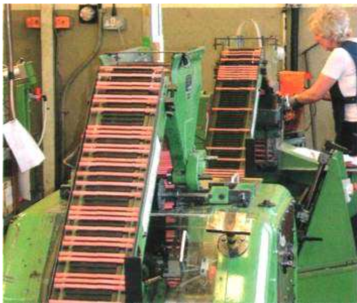
Производство карандашей. Процесс производства карандашей полностью автоматизирован. На иллюстрации показано, как происходит их маркировка и затачивание.
