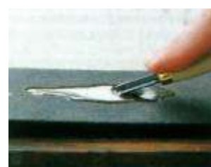
Затачивание резца в форме буквы «V». Затачивайте каждую режущую грань отдельно. После обработки форма «V» лезвия резца должна быть по-прежнему симметричной.
