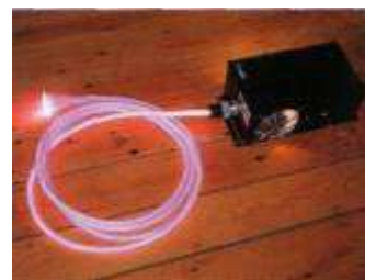
Проектор с волоконно-оптическими кабелями: малиновый фильтр
